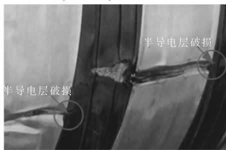
图 6 铜带褶皱边缘撑破半导电层处
